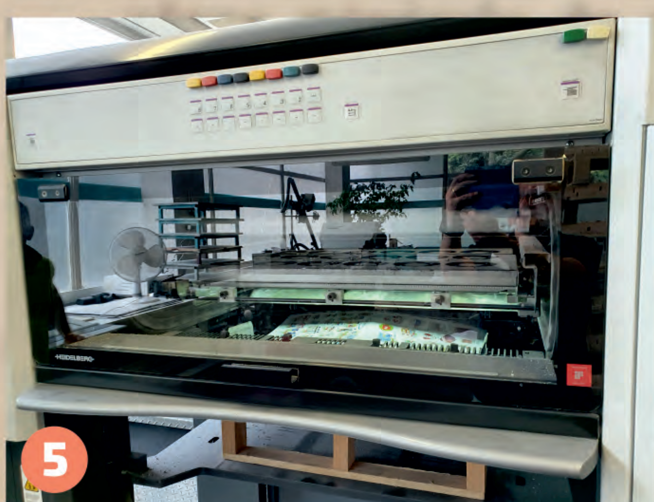
Archy potištěné z obou stran se ukládají na paletu
