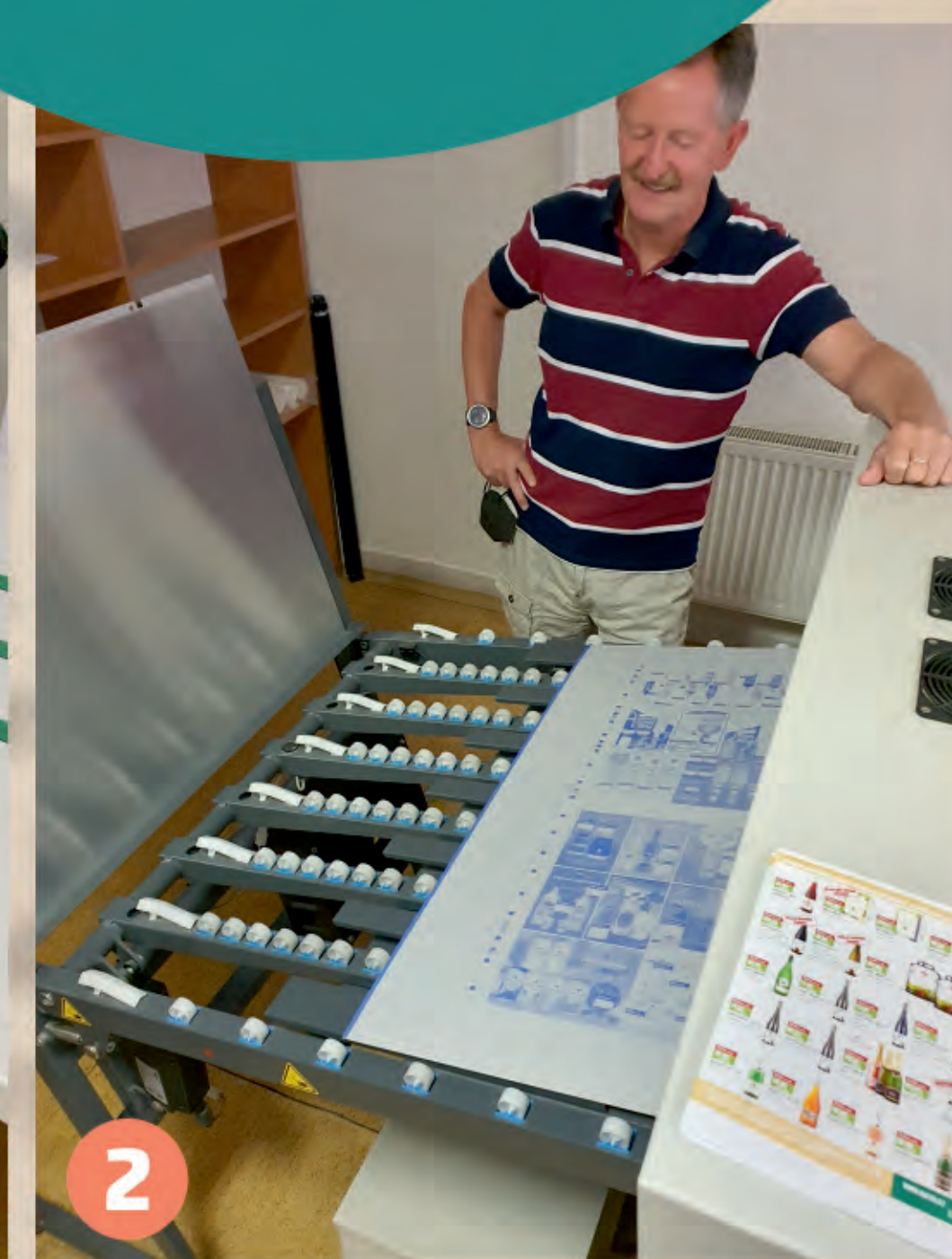
Vyvolaná fólie představuje jeden ze 4 výtazků CMYK pro tisk jedné strany archu
