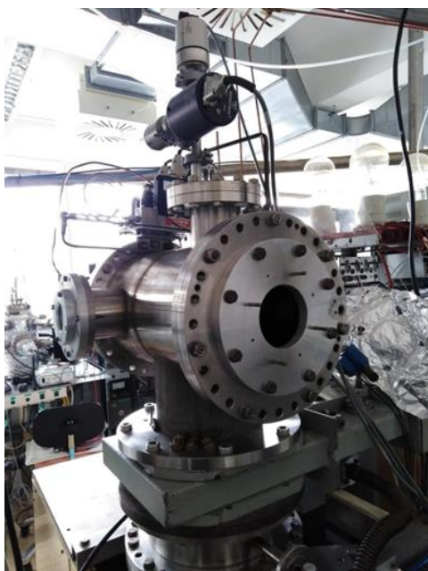
Obr. 2: Depoziční aparatura, v níž jsou připravovány vrstvy černých kovů pomocí magnetronového naprašování (vlevo). Fotografie magnetronové plazmy v průběhu depozice černého hliníku (nahore.)
