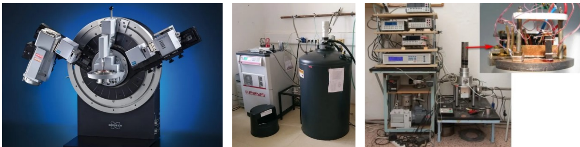
Zleva: Jádru práškového rentgenového difraktometru pro strukturní analýzu, multifunkční sestava přístroje PPMS a aparatura sestavená na FZU pro měření nízkoteplotních termoelektrických vlastností.
