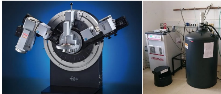
Vlevo: Jádru práškového rentgenového difraktometru pro strukturní analýzu. Vpravo: Multifunkční sestava přístroje PPMS.
