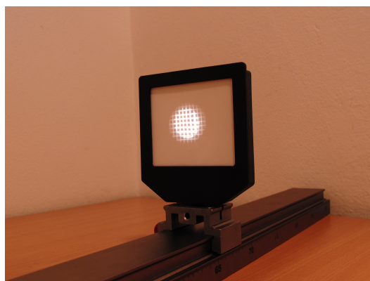
Obrázek 37: Vzorový výsledek k pokusu 5.6 Otvorová vada čočky – nahoře Varianta A, dole B
