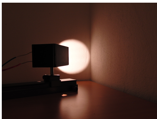
Obrázek 50: Vzorový výsledek k pokusu 7.1 Světlo odražené od bílých a od černých ploch
