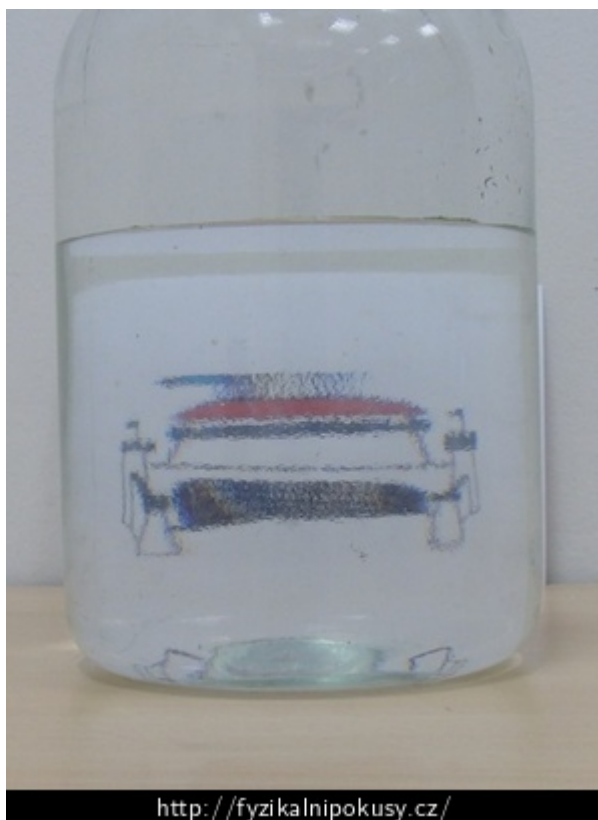
Obrázek 36: Důsledek nevhodného umístění obrázku za vodní čočkou. Převzato z elektronické sbírky (Sbírka fyzikálních pokusů, b)
