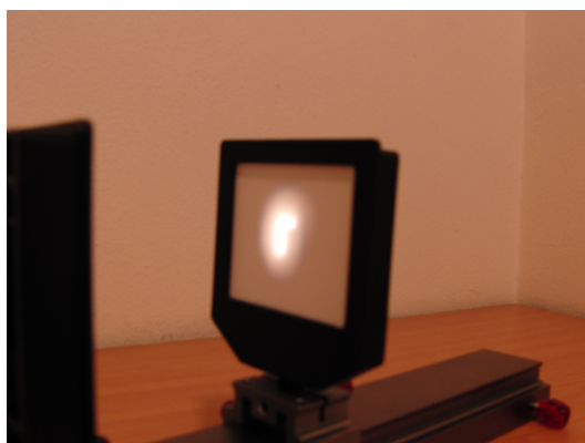
Obrázek 31: Vzorový výsledek k pokusu 5.2 Zobrazování předmětu spojkou
