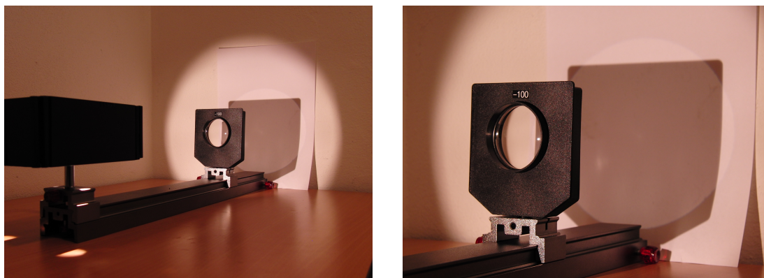
Obrázek 33: Vzorový výsledek k pokusu 5.3 Určení ohniskové vzdálenosti rozptylky
