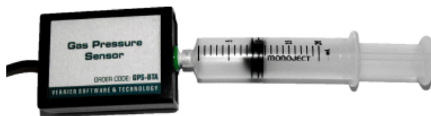
Obr. 1: Přišroubování stříkačky k čidlu tlaku
