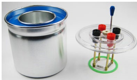
Obr. 1: Kalorimetr a topná spirála
