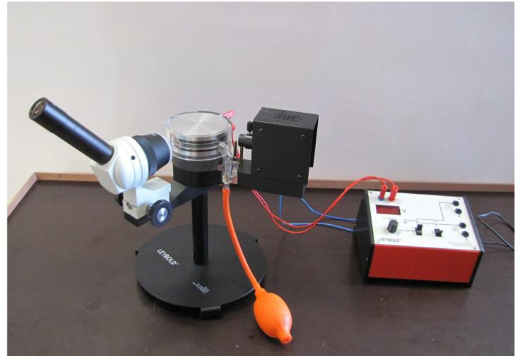
Tímto experimentem můžeme změřit elementární náboj.
